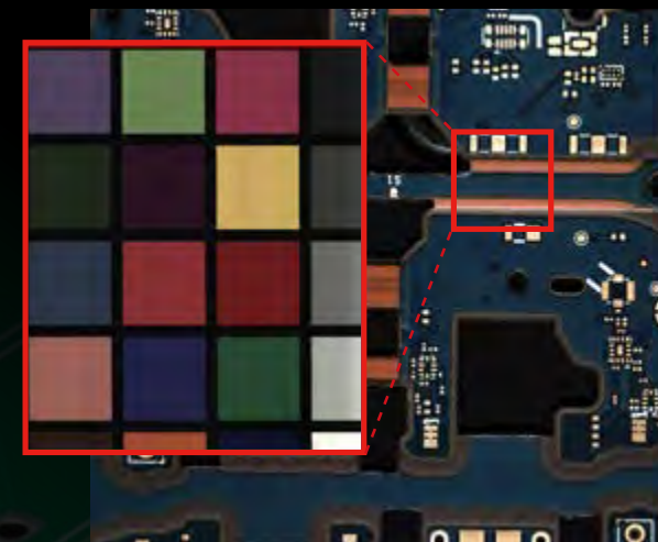
Dye filter 사용한 일반 컬러 카메라 + 색수차 제어하지 못한 렌즈
